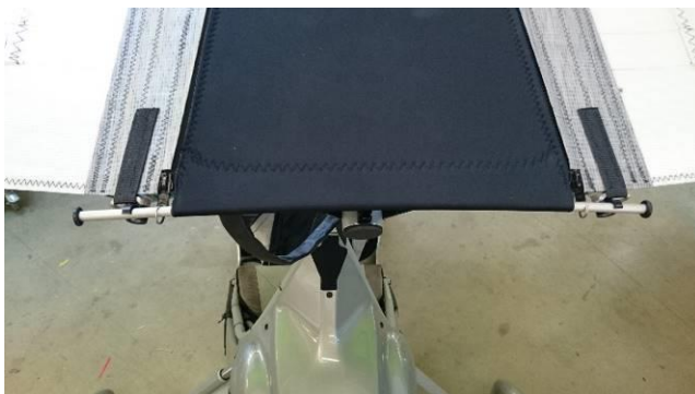
Figure 5-5 : Latte de tension de bord de fuite
