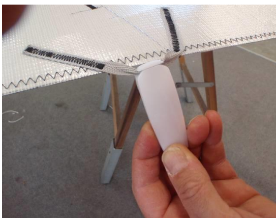
Figure 5-1 : Tendeurs de lattes Easyfit
