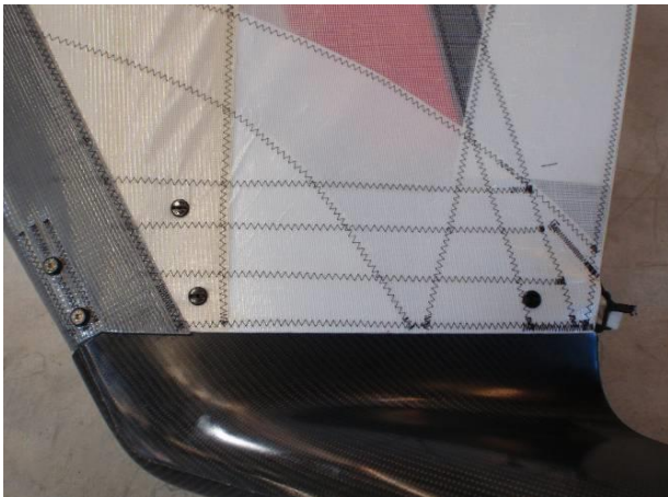
Figure 5-3 : Fixation des dérives
