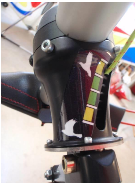
Figure 5-7 : Commande du CORSET
