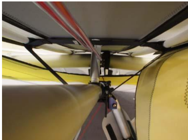
Figure 5-2 : Cheminement des câbles d'étarquage
